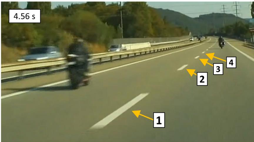
Abb. 1: Ausschnitt eines Frames vom Nachfahr-Video, in welchem das überholende Motorrad auf der linken Fahrspur zu sehen ist. Die eingefügte Nummerierung betrifft die vier Mittellinien, welche die gewählte Wegstrecke der Weg-Zeit-Analyse bilden (siehe Rz. 18 ff.).
