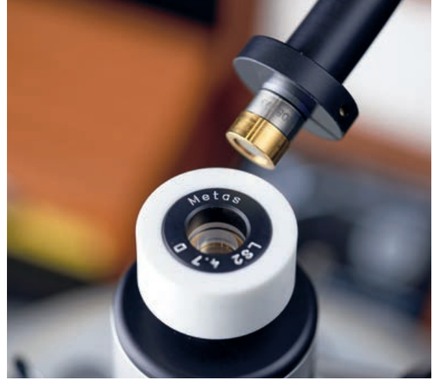
2: Ein goldfarbenes Laborstandard-Mikrophon wird mit einem Saphirkuppler an ein zweites gekoppelt.
