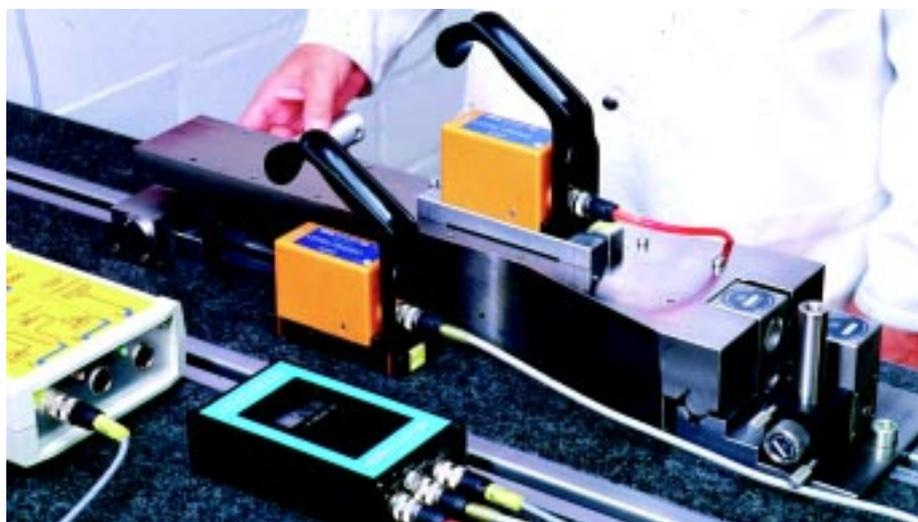
**Figur 10: Aufbau zur Kalibrierung von elektronischen Neigungsmessern auf einem Neigungsbalken.**
