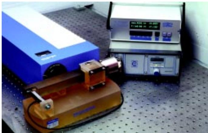
**Figur 8: Aufbau zur Kalibrierung eines Autokollimators mit Hilfe eines Zerodur-Sinuslineals.**
