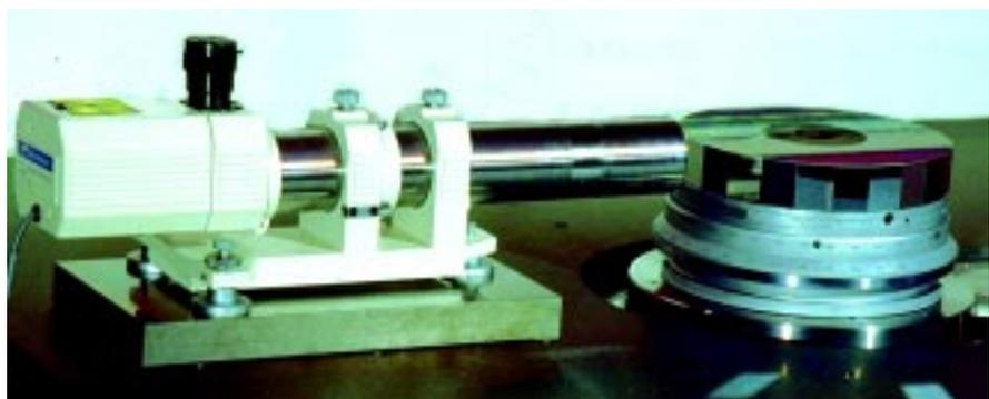
**Figur 2: Messaufbau für Kalibrierung nach dem Dreirosettenverfahren.**
