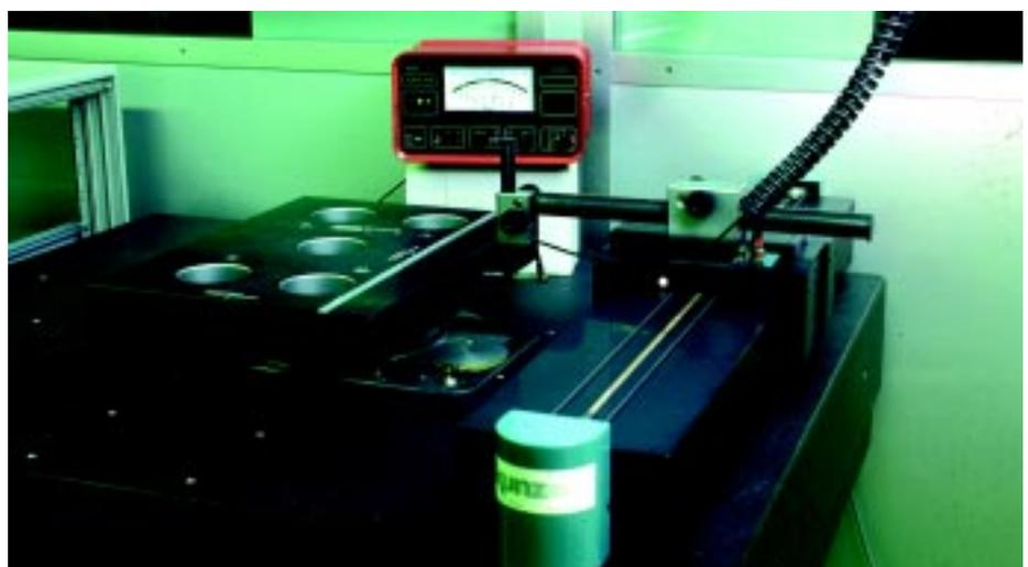
Figur 7: Aufbau zur Kalibrierung eines Hartgesteinswinkels auf dem Winkelmesstisch durch Geradheitsmessung der Messflächen.
