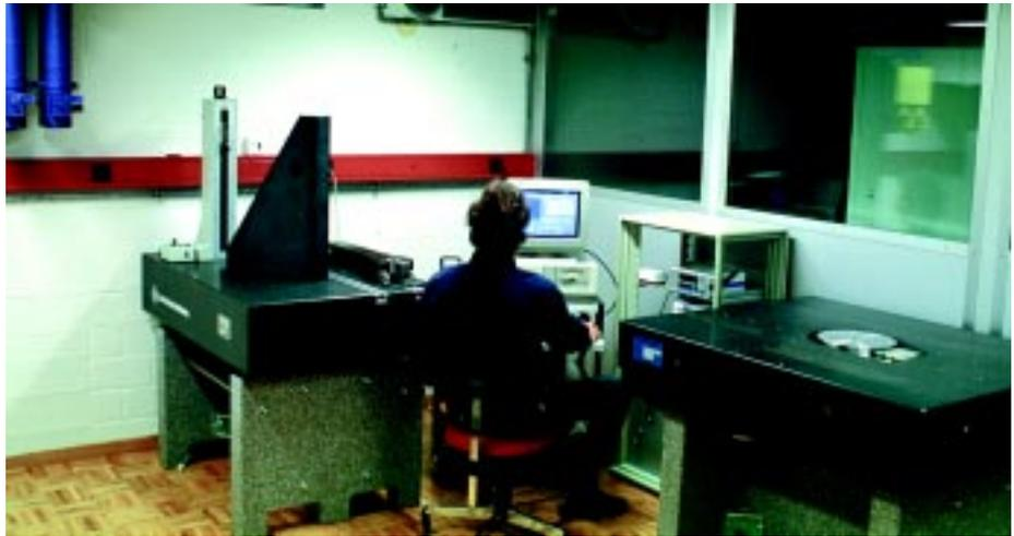
**Figur 1: Winkellabor des EAM mit dem neuen, numerisch gesteuerten Winkelmeßstisch (rechts im Bild).**
